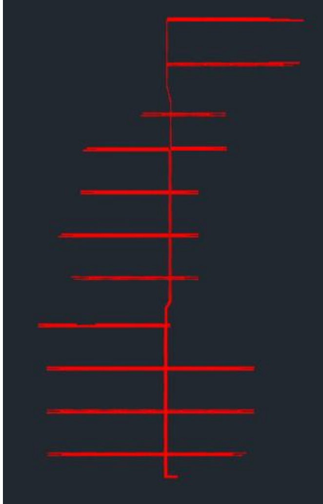
Figura 5-3. Malla de puesta a tierra representada por conductor de cobre enterrado.
