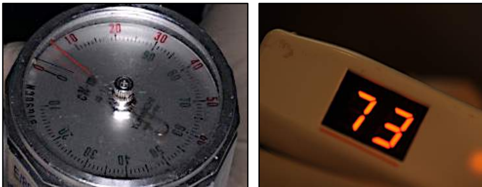
Ilustración 39. Lecturas de valores de TI (torquímetro) y AFR (valor ISQ)
