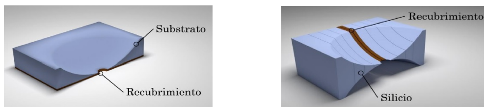
Figura 3.7: Preparación de muestras para ser observadas al TEM, superficie (izquierda) y sección transversal (derecha). Queda un agujero a través del cual pasa el haz de electrones.
