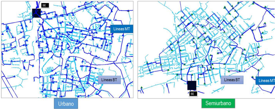
Figura 1: Ejemplo de red BT real bajo la red MT
