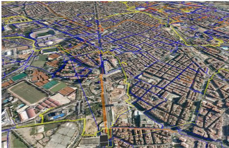
Figura 11: Ejemplo de análisis de cumplimiento de restricciones electro-técnicas por saturación (naranja >80% sat.; rojo >100% sat.; amarillo >120% sat.)
