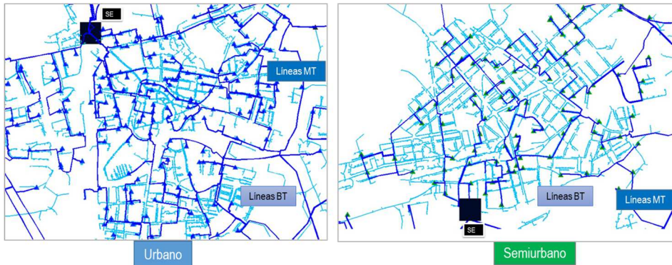
Figura 21: Detalle de redes de MT y BT en unas zonas urbana y semiurbana
