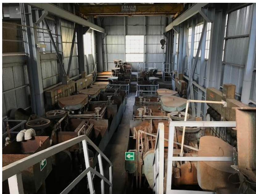
Figura 17. Departamento celdas de flotación. Laveria Fioretti (Foto Mossa)
