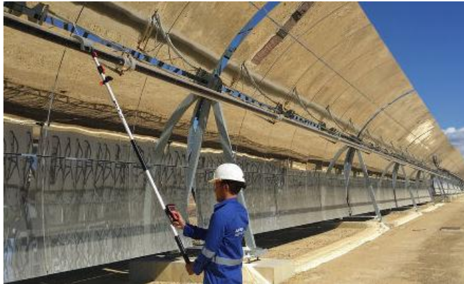
Figura 3-17. Operario evaluando un tubo receptor con el ThermoHook [95].
