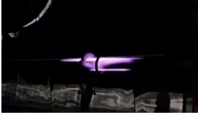
Figura 6-4. Plasma generado en un tubo receptor.
