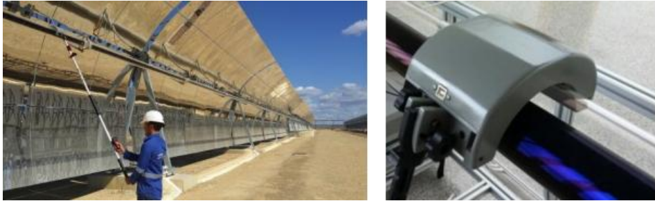
Figura 2-49. (a) Evaluación en campo usando y (b) cabezal de medida del dispositivo de evaluación de temperaturas del tubo receptor [95].
