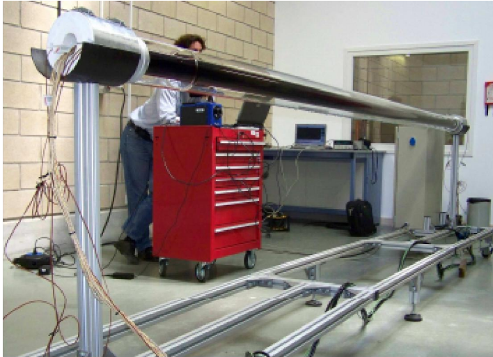
Figura 2-40. Banco de evaluación de pérdidas térmicas desarrollado por Cener [80].
