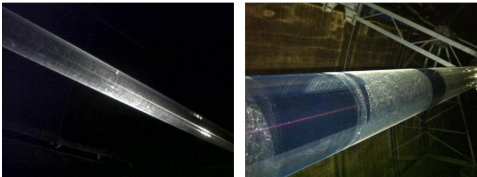
Figura 4-9. (a) tubo receptor tras limpieza por dilución; (b) dos de las zonas seleccionadas tras aplicar la limpieza a mano en contraste con la superficie del tubo tras limpieza por dilución.
